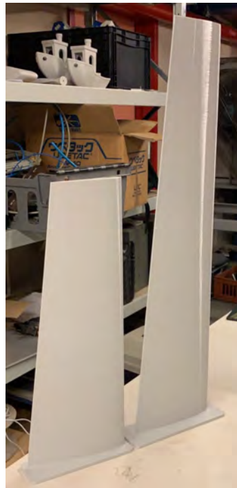
Figuur 12.9: NACA 1412 met verschillende hoogtes
