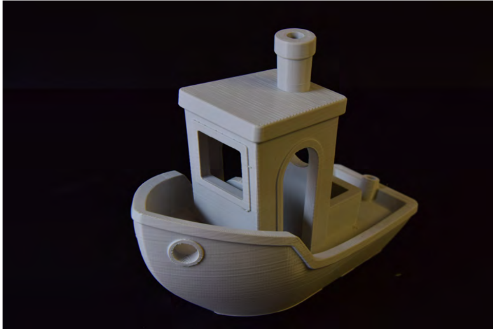
Figuur 12.10: Benchy, Mondstuk-diameter: 0.6, Printsnelheid: 30 mm/s, Infill: 10%, Schaalfactor: 400%, Printtijd: 14u
