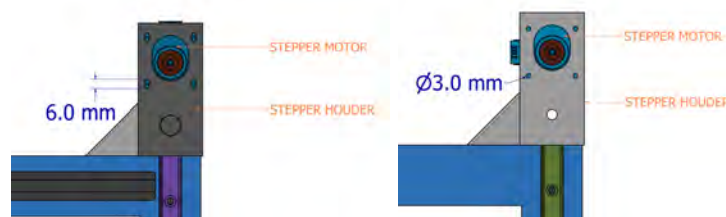
Figuur 9.13: Links is de verbeterde en laatste versie van de stepper houder, rechts het oorspronkelijk ontwerp ervan. Oorspronkelijk was de opening een gat van drie millimeter. Door de gat te veranderen in een ovaalgat is het mogelijk om aan de motor te trekken, de riem op te spannen en vervolgens vast te schroeven.
