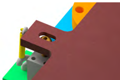
Figuur 5.1: De pitchschroef op de x-richting aan de linkerkant van het bed.
